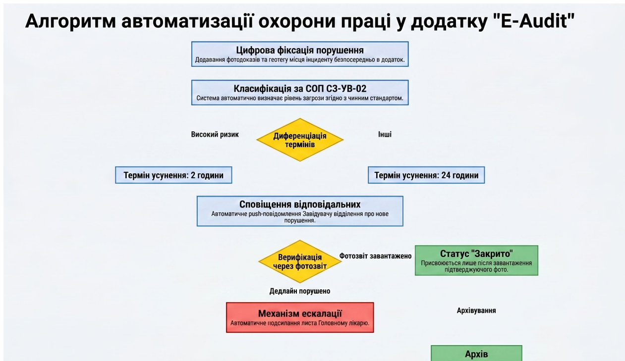
Рисунок 3.2 – Блок-схема спрацювання смарт-системи захисту E-Audit
