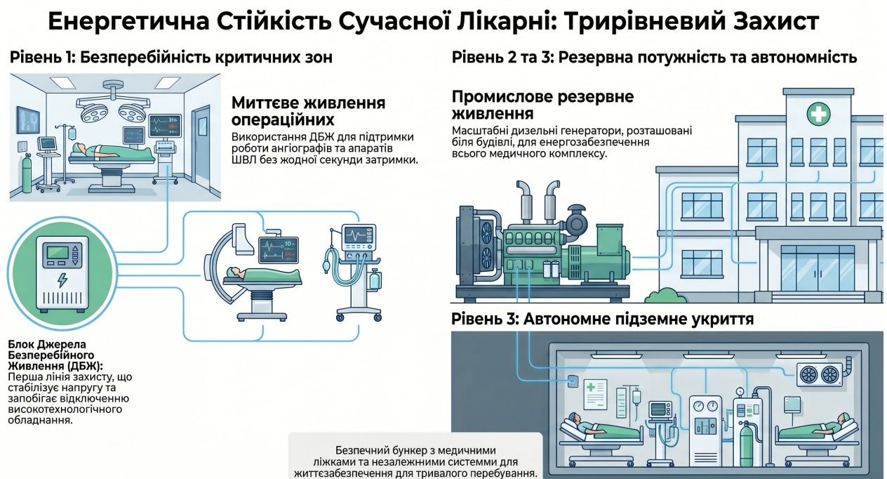
Рисунок 4.2 – Трирівнева архітектура резервного енергозабезпечення операційної в умовах воєнного стану
