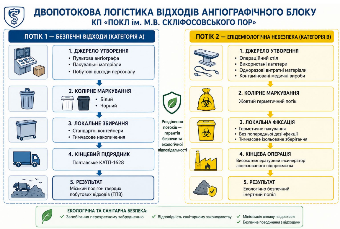
Рисунок 5.1 – Схема двопотокової логістики та управління відходами в ангіографічному блоці
