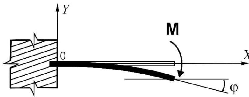
Рисунок 6.4 – Зображення кута повороту перерізу від дії на балку зосередженого моменту M
