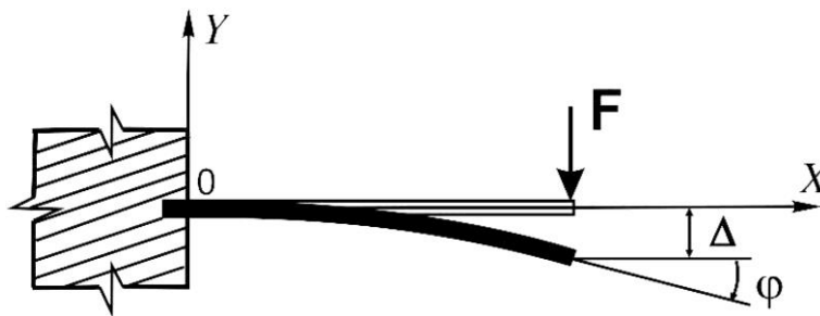
Рисунок 6.3 – Переміщення точки прикладення сили за напрямком її дії
