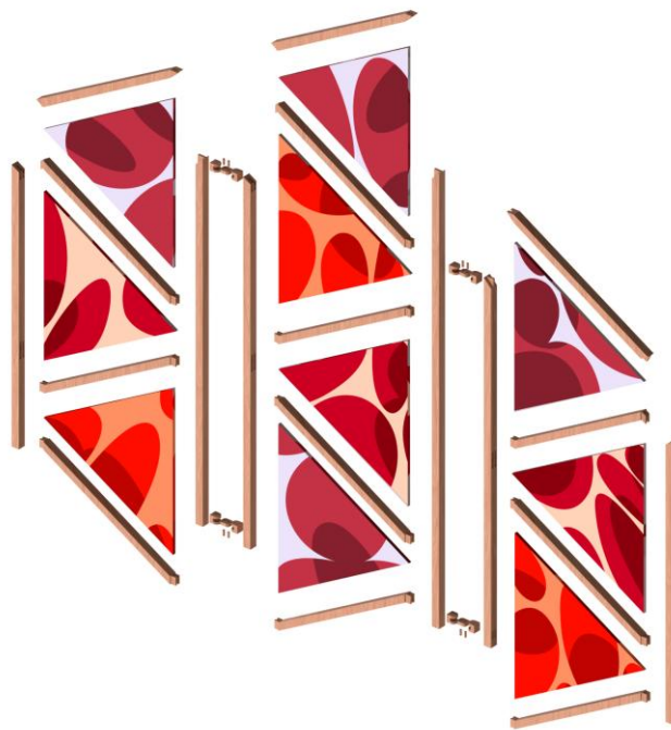
Рис. 3.4 Аксонометрична вибух-схема (exploded view) дерев'яного каркаса ширми із зазначенням елементів конструкції
