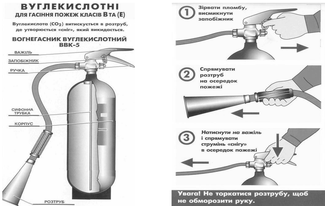
Рисунок 8.6 – Будова і порядок роботи вогнегасника ВVK-5
