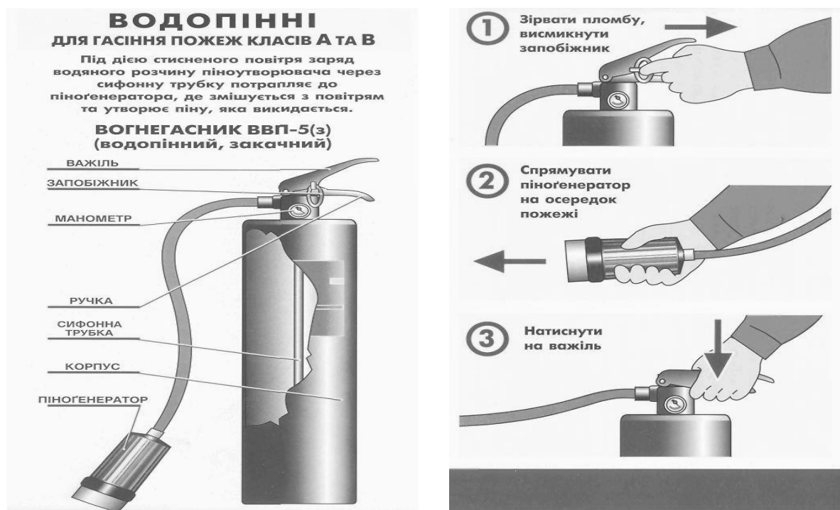
Рисунок 8.3 – Будова і порядок приведення в дію ВВП
