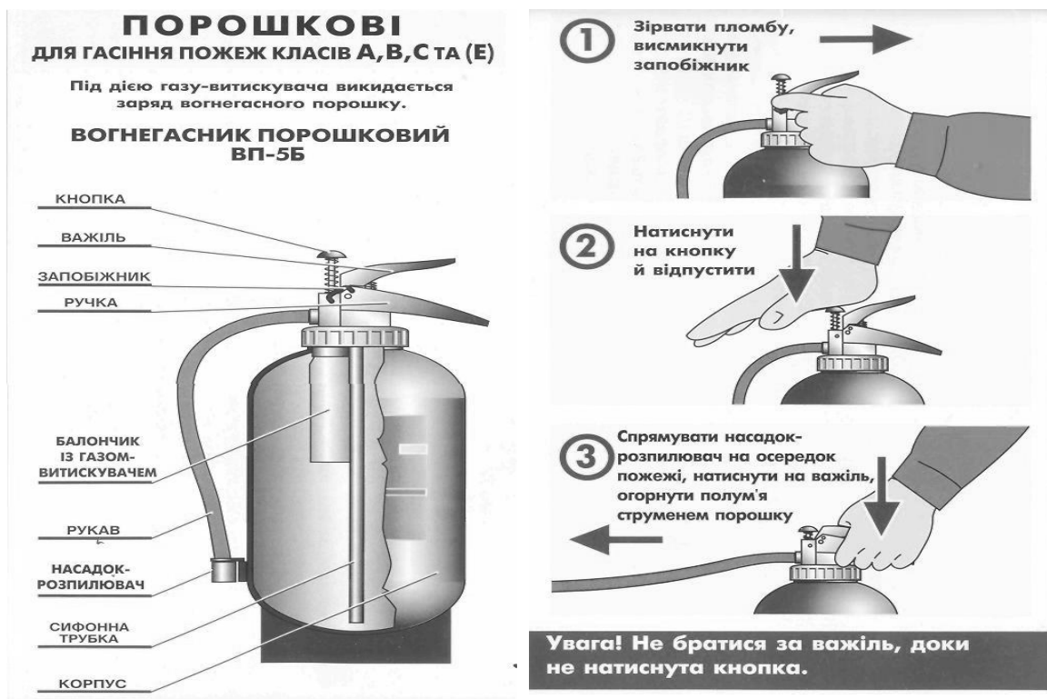
Рисунок 8.8 – Будова і порядок роботи ВП-5Б
