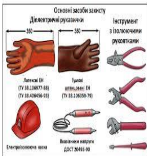
Рисунок 5.1 – Основні засоби захисту в електроустановках із напругою до 1 000 В
