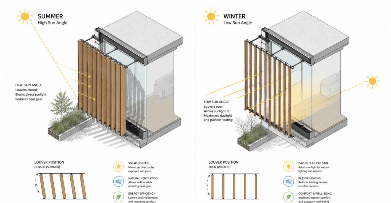
Рисунок 1.11. Схема роботи системи фасадних ламелей
