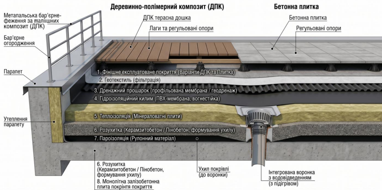
Рисунок 3.1. Схема конструктивного вузла експлуатованої покрівлі
