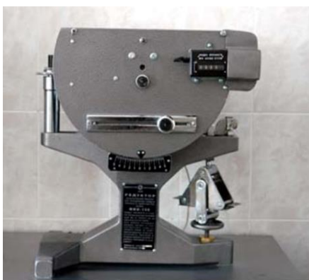
Рисунок 5.6 – Прилад-автомат МВВ-100 для випробування зразків на вигин (URL: https://rcf.khadi.kharkov.ua/laboratoriji/laboratorija-neorganichnikh-vjazhuchikh-ta-cementobetoniv/ )
