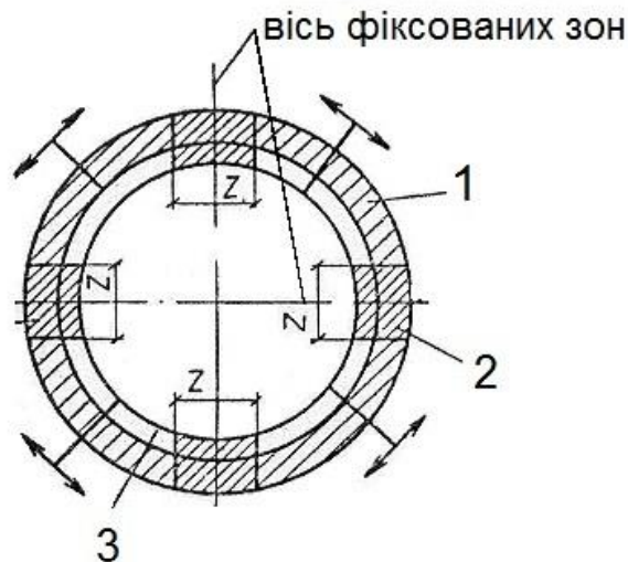
Рисунок 5.2 – Схема розробки ґрунту під ножем колодязя:
