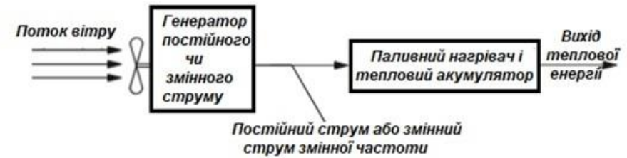
Автономна ВЕУ для отримання теплової енергії
