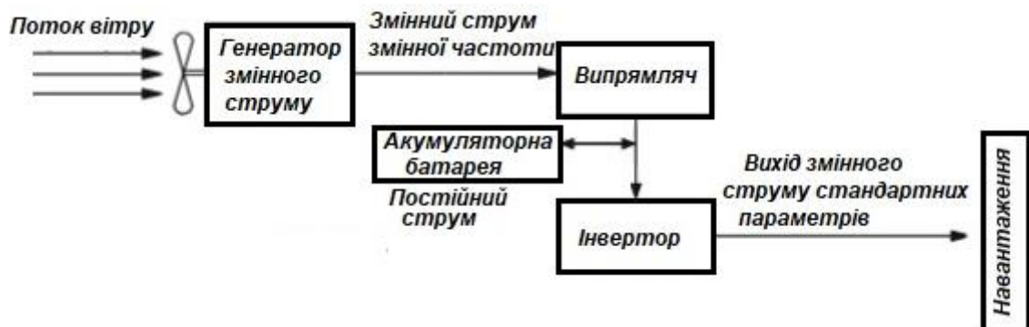
Рисунок 2.5 – Структурна схема автономної ВЕУ для отримання електричної енергії стандартних параметрів [7]
