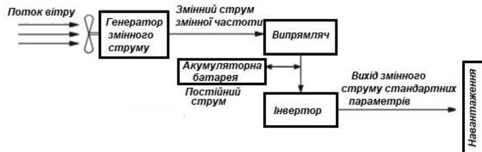
Автономна ВЕУ для отримання електроенергії стандартних параметрів
