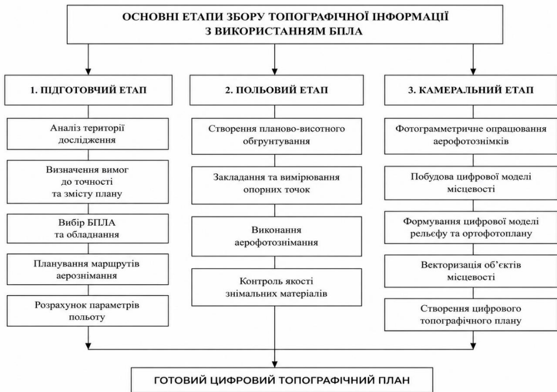
Рисунок 1.1 – Основні етапи збору топографічної інформації з використанням БПЛА
