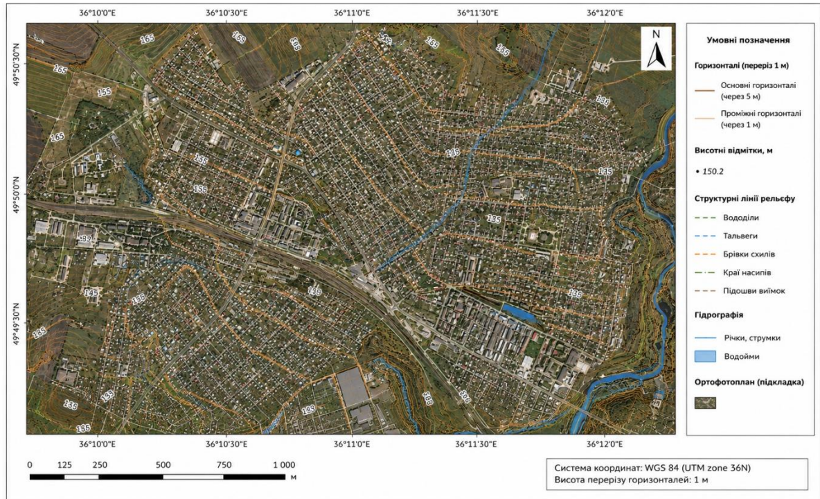
Рисунок 3.8 – Формування рельєфу території під час створення цифрового топографічного плану
