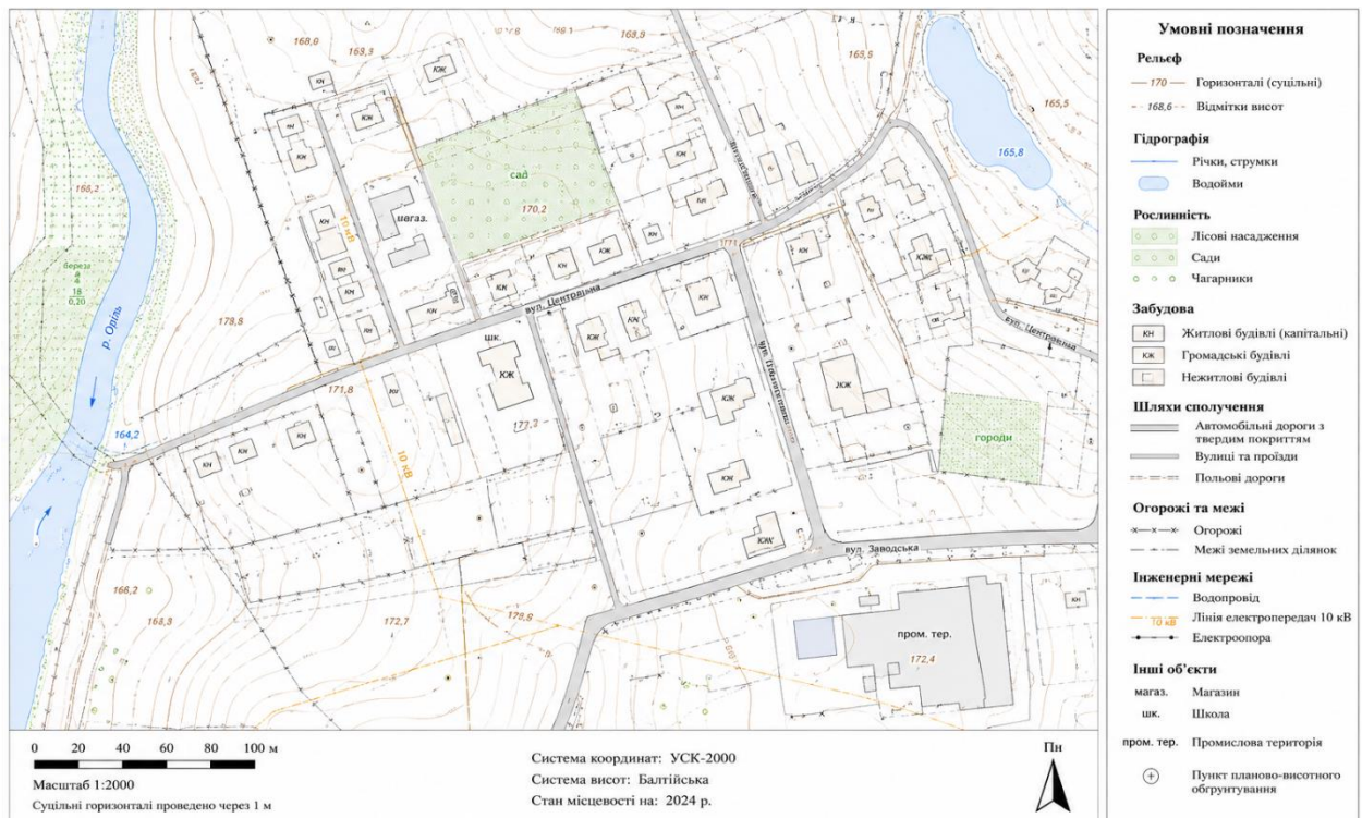
Рисунок 2.9 – Фрагмент цифрового топографічного плану масштабу 1:2000 території дослідження
