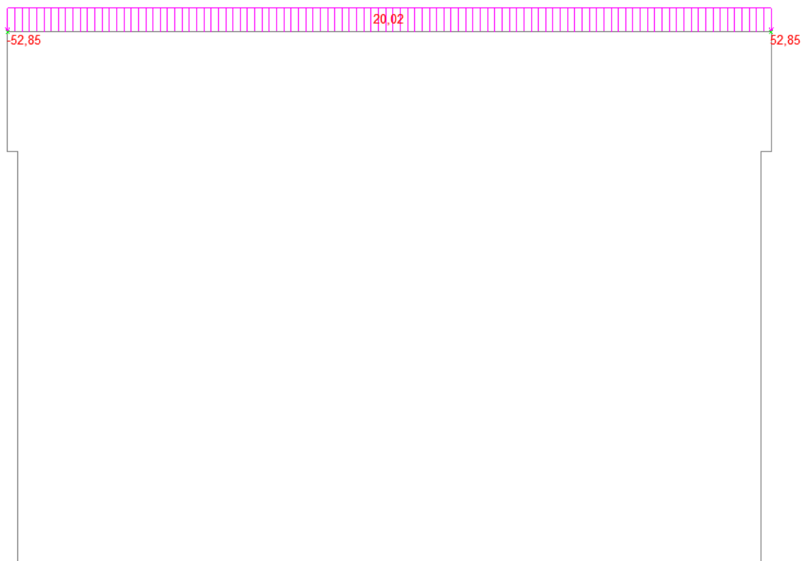
Рис.2.1.3 Схема прикладання снігових навантажень
