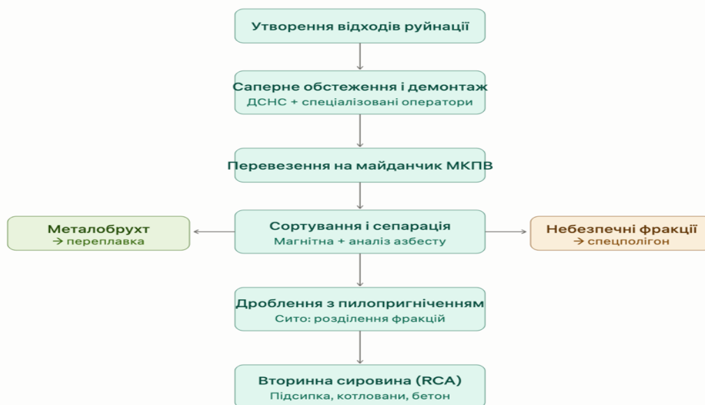
Рисунок 3.2 – Технологічна блок-схема процесу поводження з відходами руйнації на майданчику КП «МКПВ»
