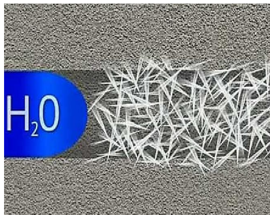
Рисунок 15.5 – Принцип дії проникної гідроізоляції
