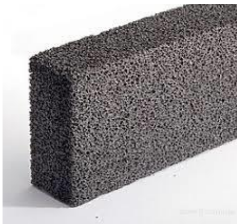
Рисунок 5.11 – Ніздрювата структура піноскла
