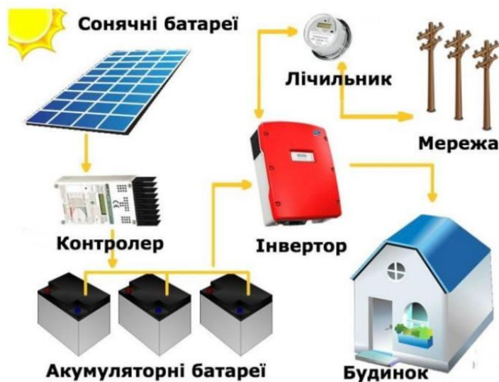
Рисунок 2.2. Схема сонячної електростанції
