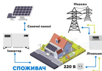
Рисунок 3.2 Типова схема функціонування сонячної станції
