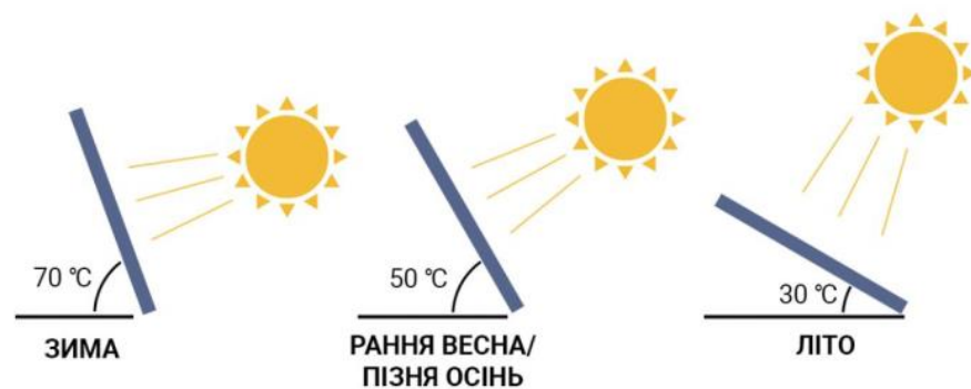
Рис. 3.1 Оптимальний кут нахилу ФЕП відносно сонця
