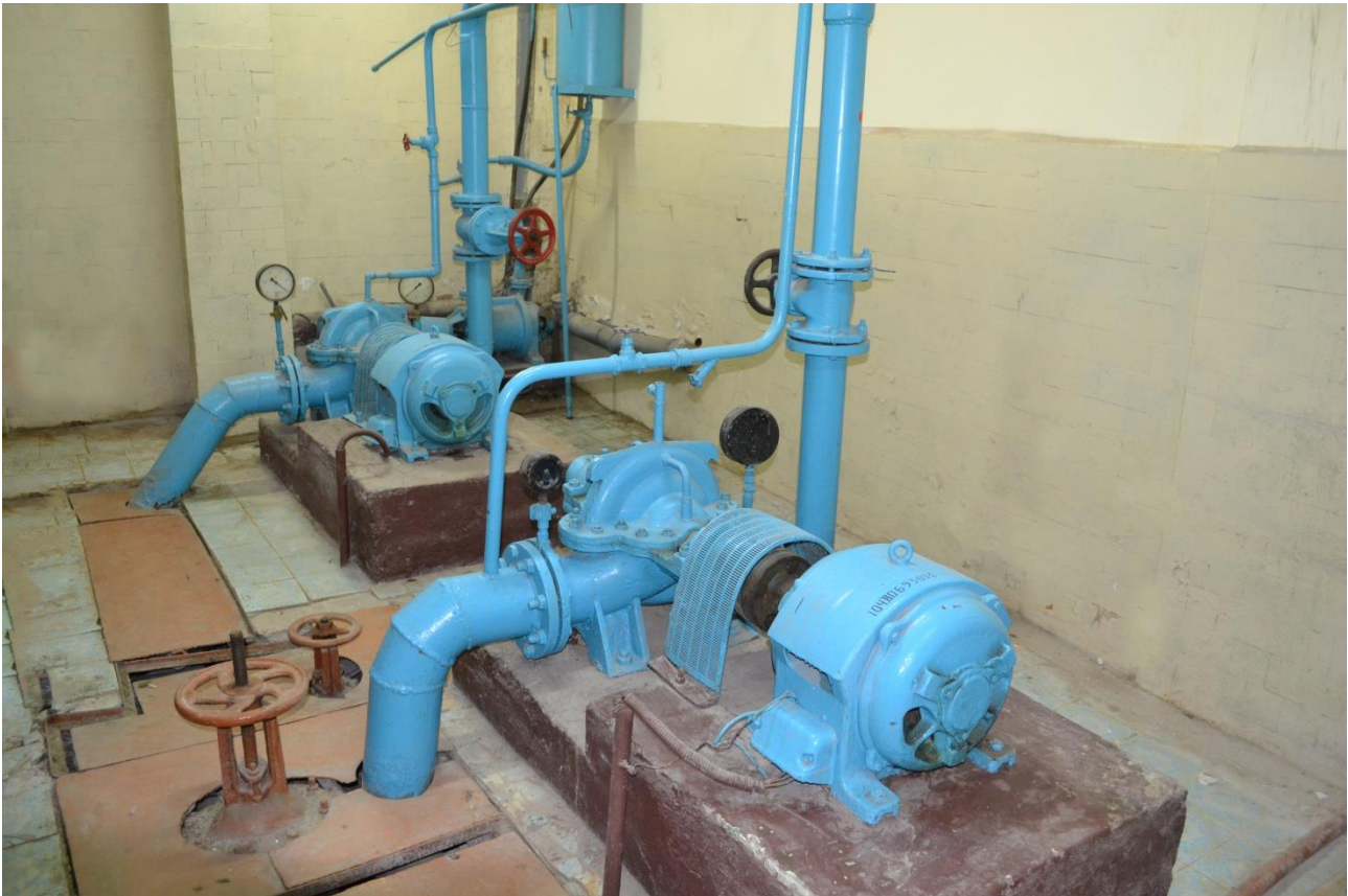
Рисунок 1.5 – Фото лабораторної установки з відцентровими насосами Д100-24
