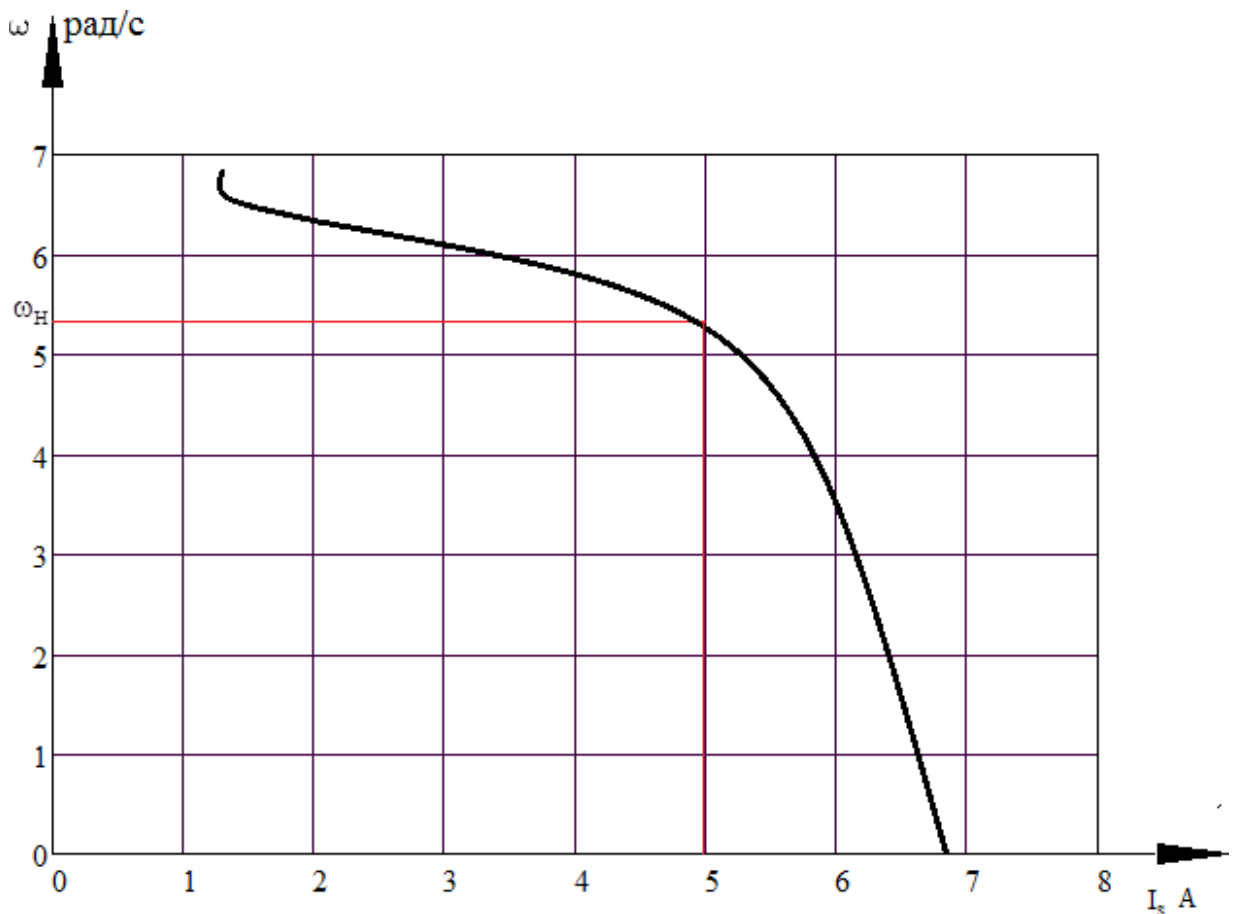
Рисунок 14 - Електромеханічна характеристика ТАД у номінальному режимі роботи
