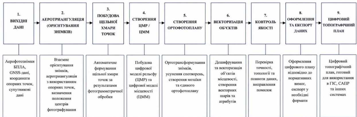
Рисунок 2.3 – Технологічна схема камеральної обробки матеріалів аерофотознімання та дистанційного зондування Землі
