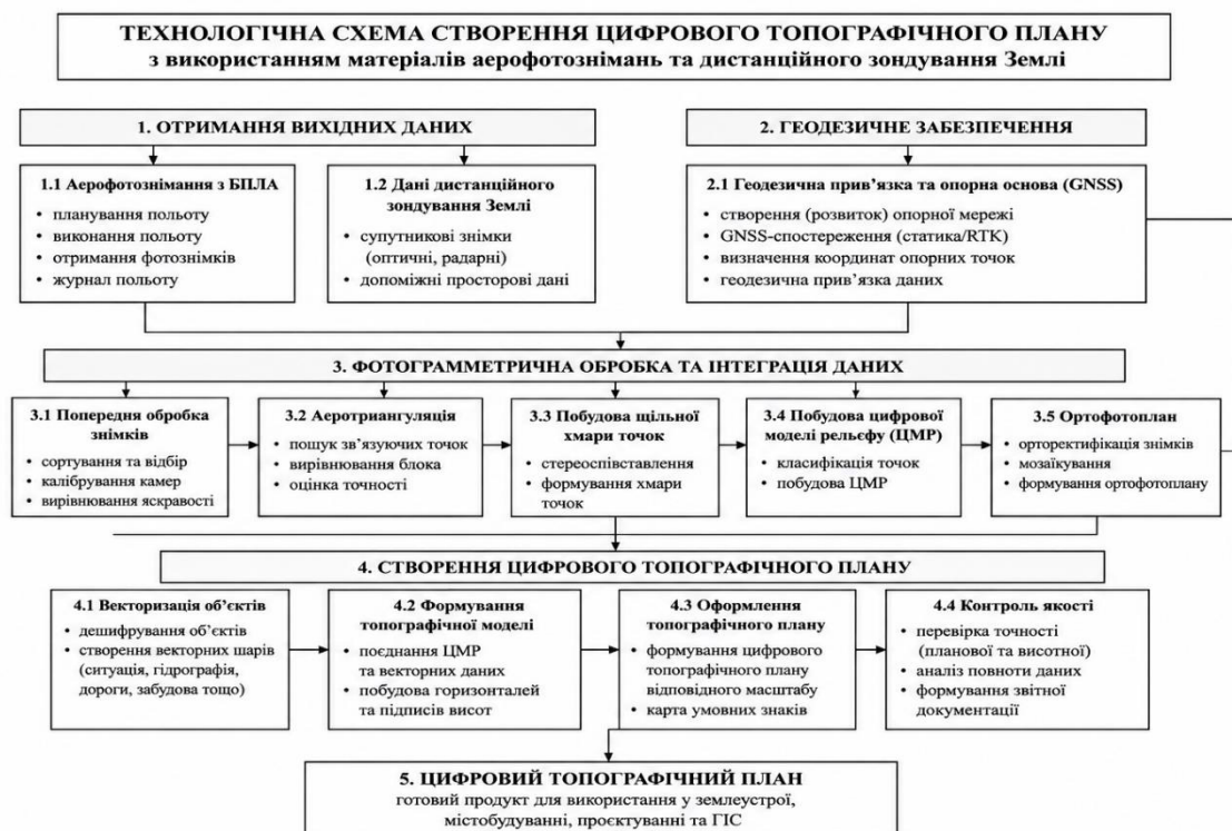
Рисунок 1.2 – Технологічна схема створення цифрового топографічного плану з використанням матеріалів аерофотознімань та дистанційного зондування Землі
