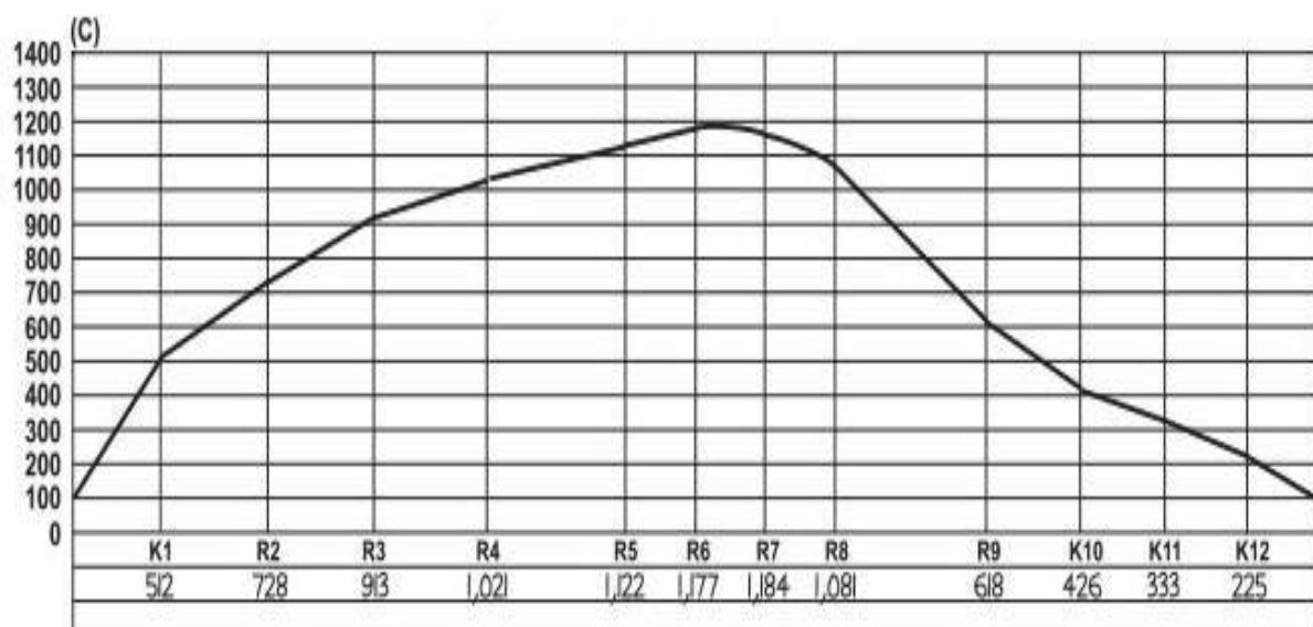
Рисунок 3.22 – Температурна крива режиму випалу керамограніту
