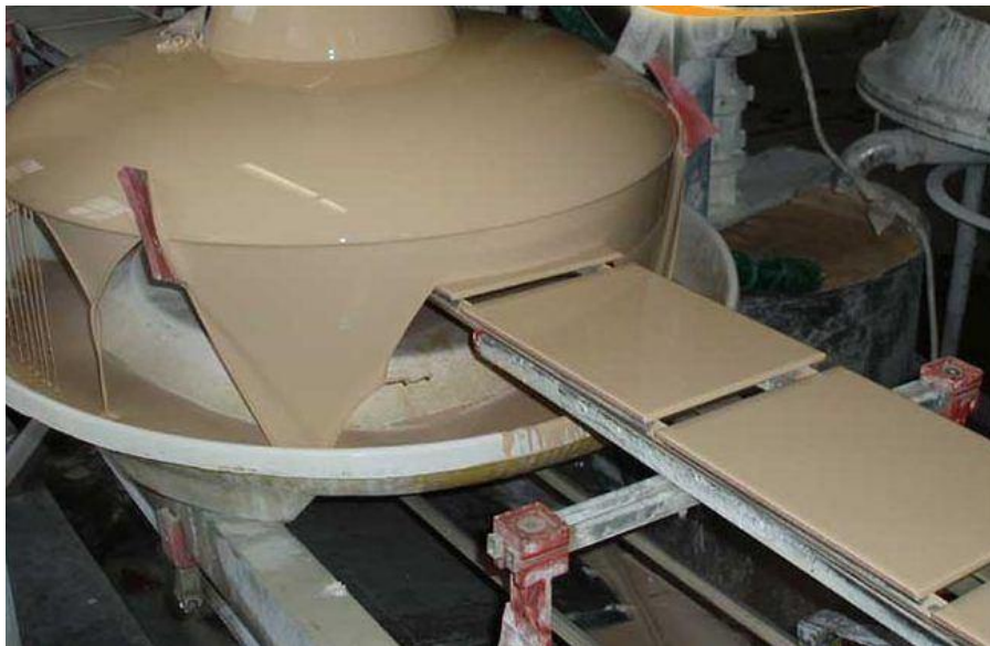
Рисунок 3.23 – Нанесення глазурі на керамічну плитку
