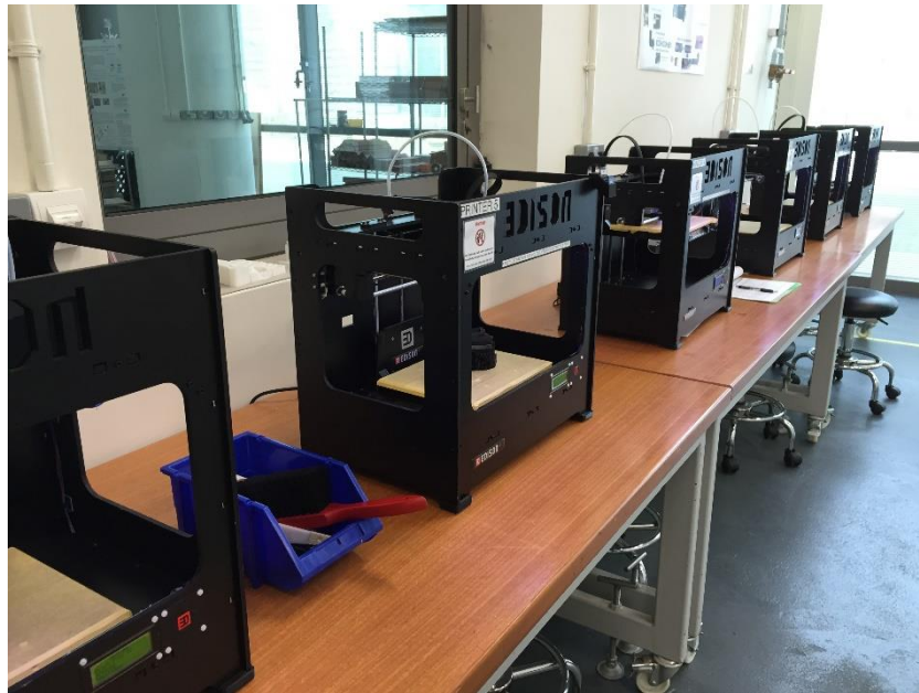
Рисунок 2.1. FDM-3D-принтери у навчальній лабораторії
