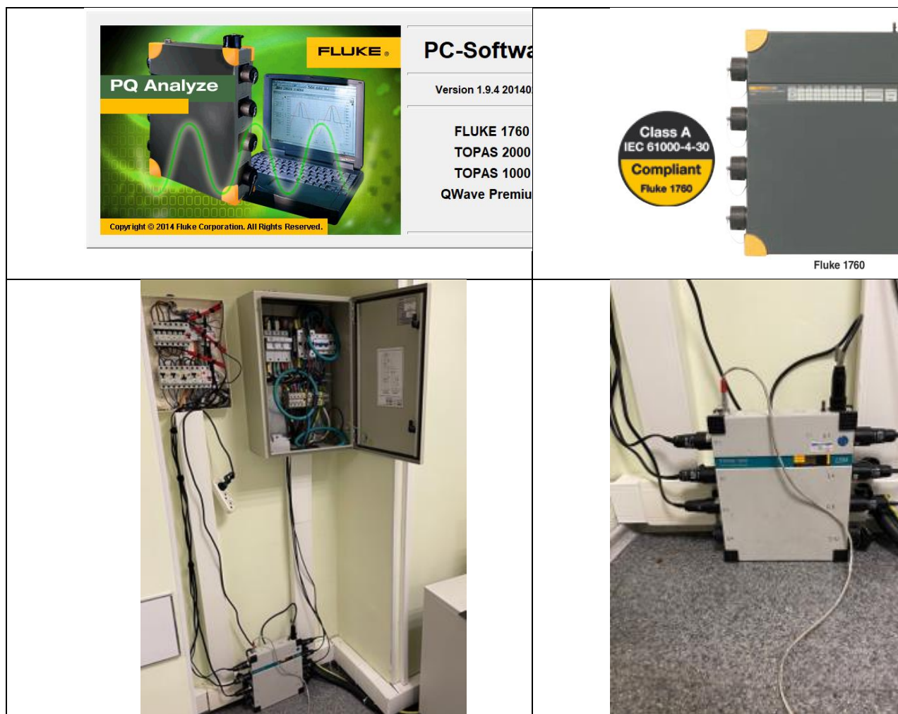
Рисунок 5.1 – Трифазні аналізатори TOPAS-1000, FLUKE-1760 TOPAS та їх підключення до мережі
