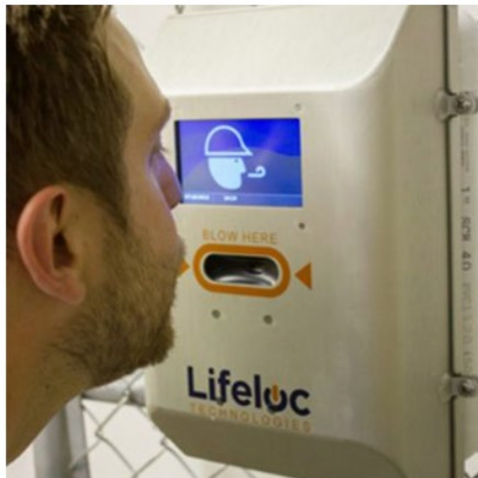
Рисунок 2.8 – Автоматизований скринінг на алкоголь та контроль доступу Lifeloc Sentinel [24]
