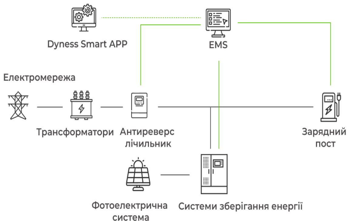
Рис. 3.7 – Інтегрована система зберігання та зарядки фотоелектричних модулів [23]
