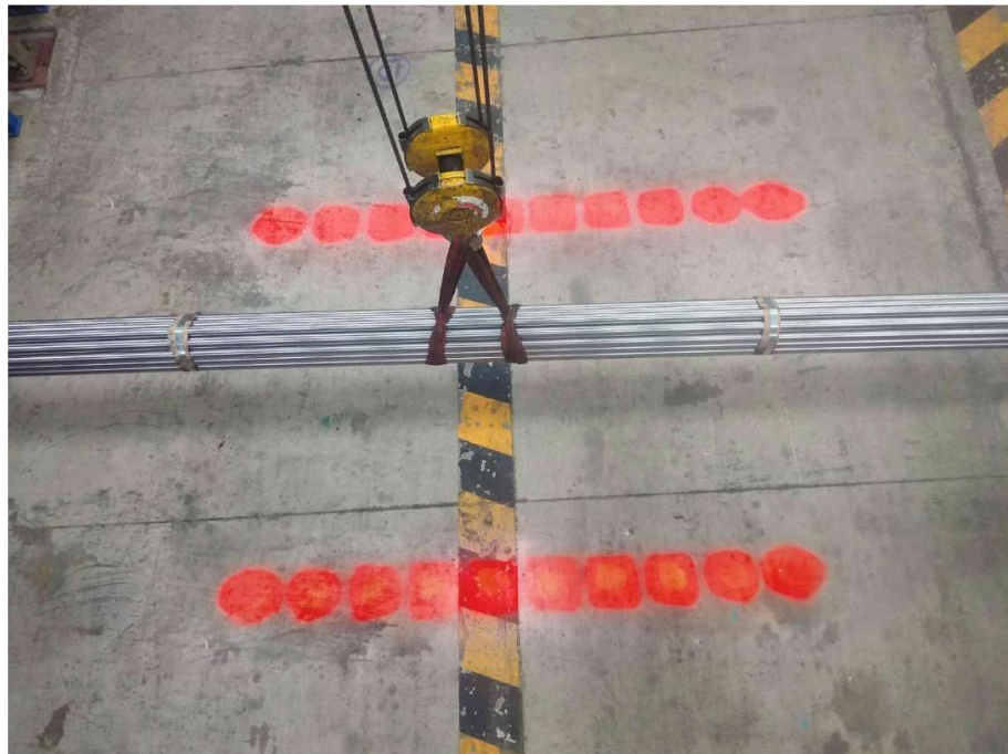
Рисунок 3.4 – Приклад використання системи лазерної світлової проєкції сигнальних ліній [40]
