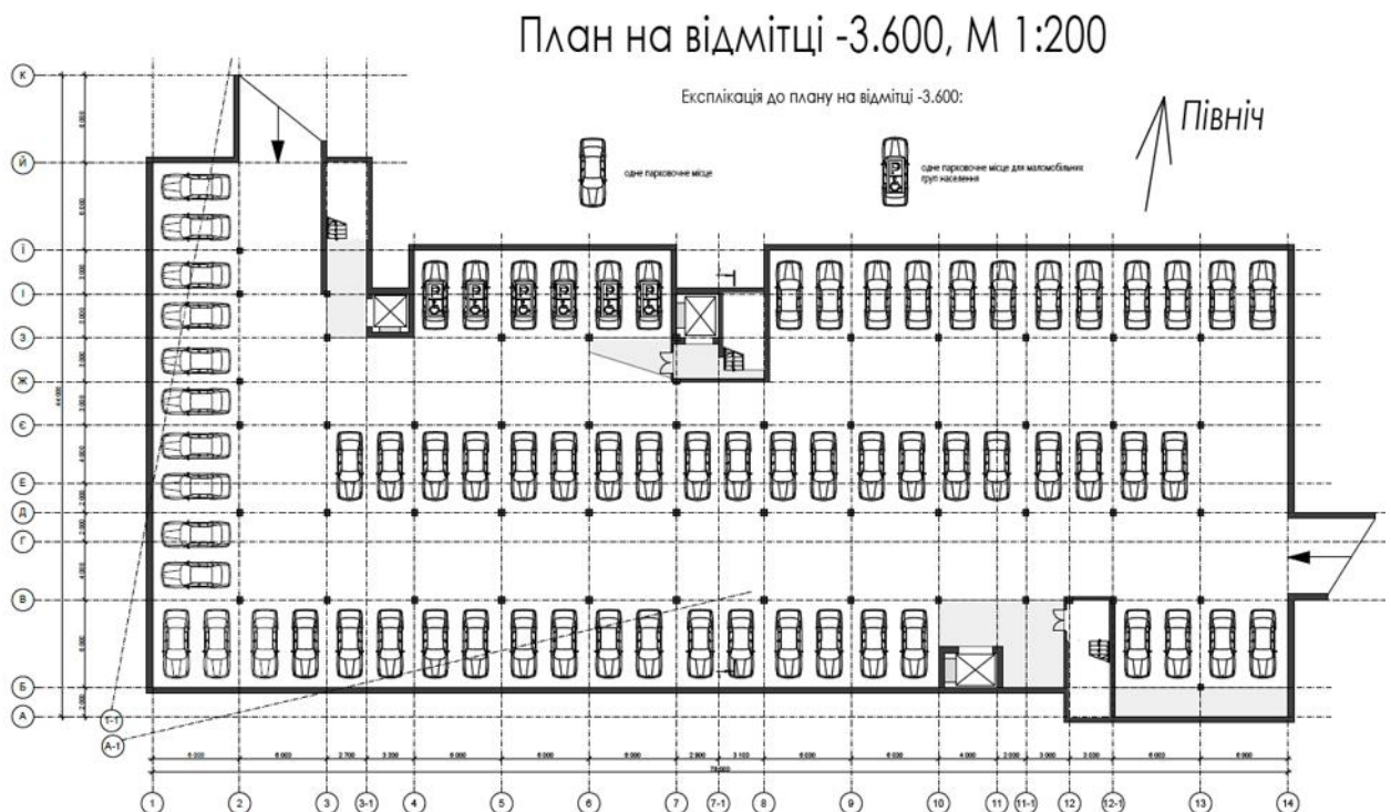
Рисунок 23. План підземного рівня нової будівлі – торговельного центру
