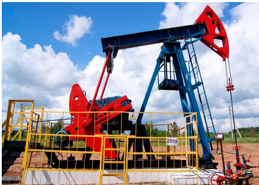
Рисунок 12.4 – Загальний вигляд штангової свердловинної насосної установки з балансирним верстатом-гойдалкою https://powercs.kz/catalog/primenenie-potrasyam/nftegozovaya-promishlennost/shtangoviy-glubinniy-nasos/
