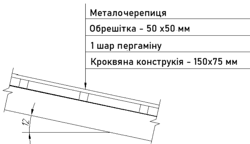
Рисунок 2.1 – Склад покрівлі
