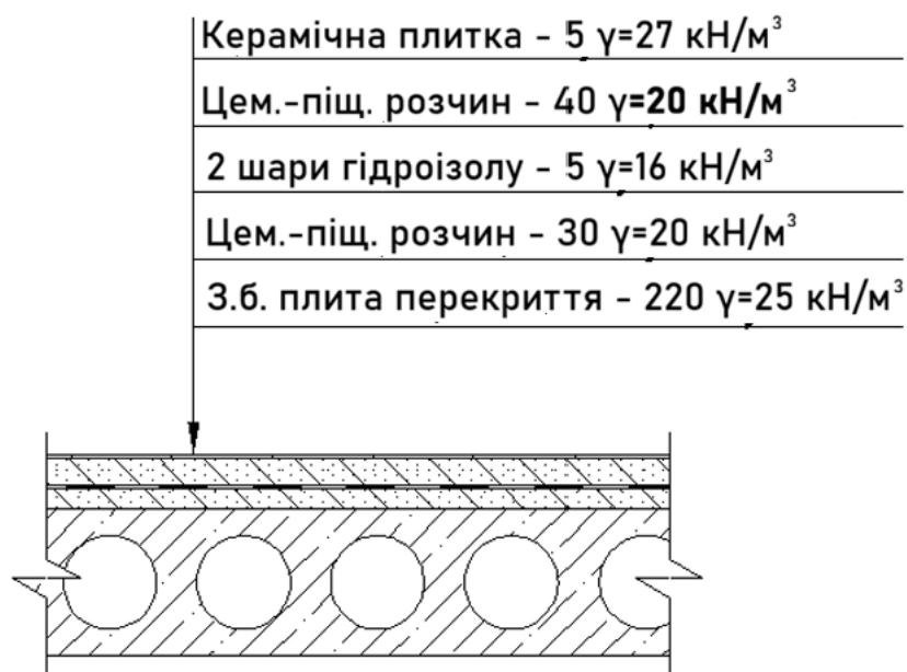
Рисунок 2.4 – Склад перекриття 1-го поверху
