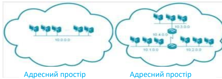
Рисунок 6.10 – Розбивка мережі на підмережі [3]
