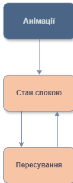
Рисунок Б.2 – UML-діаграма зміни станів анімацій для противників
