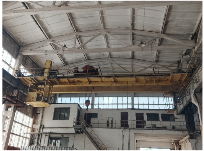
Рисунок 1.4 – Мостовий промисловий кран КМ-10 вантажно-розвантажувальної дільниці
