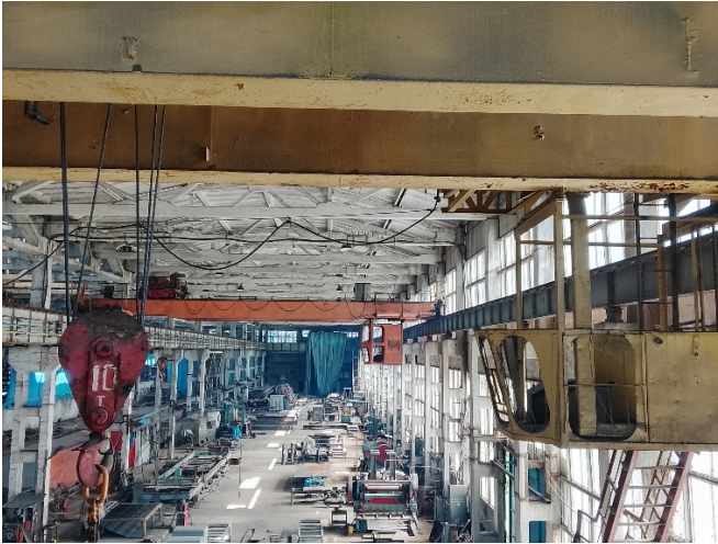
Рисунок 1.4 – Мостовий промисловий кран КМ-10 вантажно-розвантажувальної дільниці
