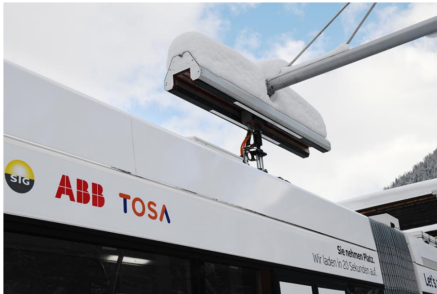
Рисунок 1.3 – Система швидкого заряджання TOSA, встановлена на одній із зупинок у Женеві
