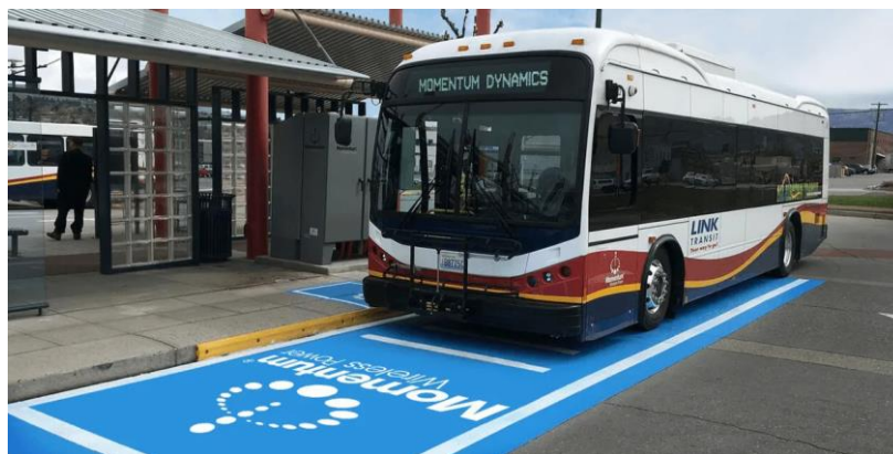
Рисунок 1.4 — Безконтактна індукційна зарядка електробуса на зупинці
