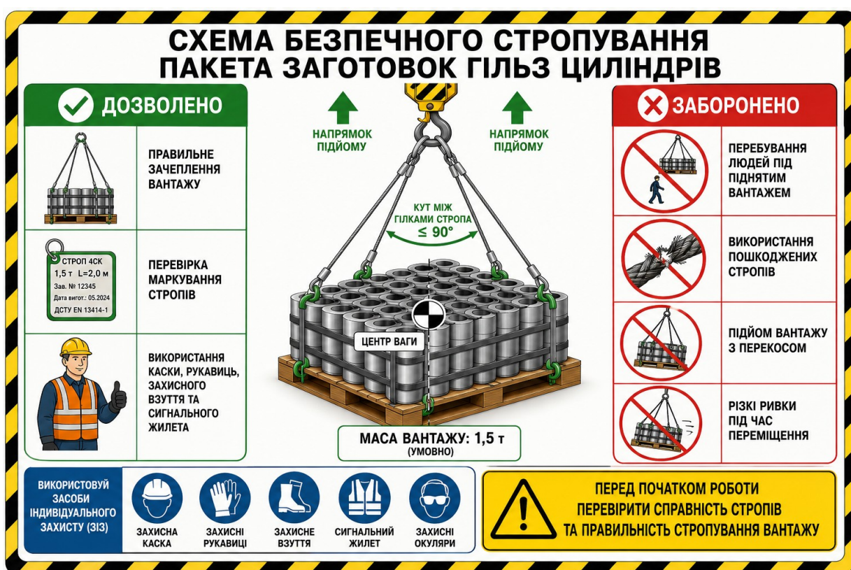
Рисунок 3.1 – Пропозиції щодо оновлення схем стропування гільз циліндрів
