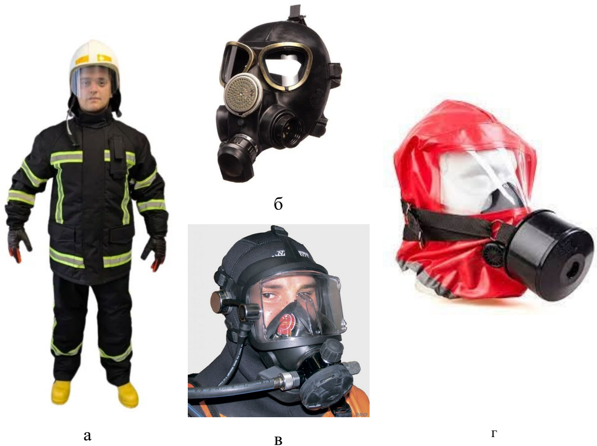
Рисунок 2.1 – Індивідуальні засоби захисту пожежних: а -захисний костюм пожежного «Феникс standart» (тканина має 3 ступені захисту); б - протигаз ІЗОД-2 CBRN; в - повнолицьова маска КАМПО ВМ-6 з гарнітурою радіозв'язку; г - захисний газодимозахисний комплект ГДЗК «БРИЗ-3401»
