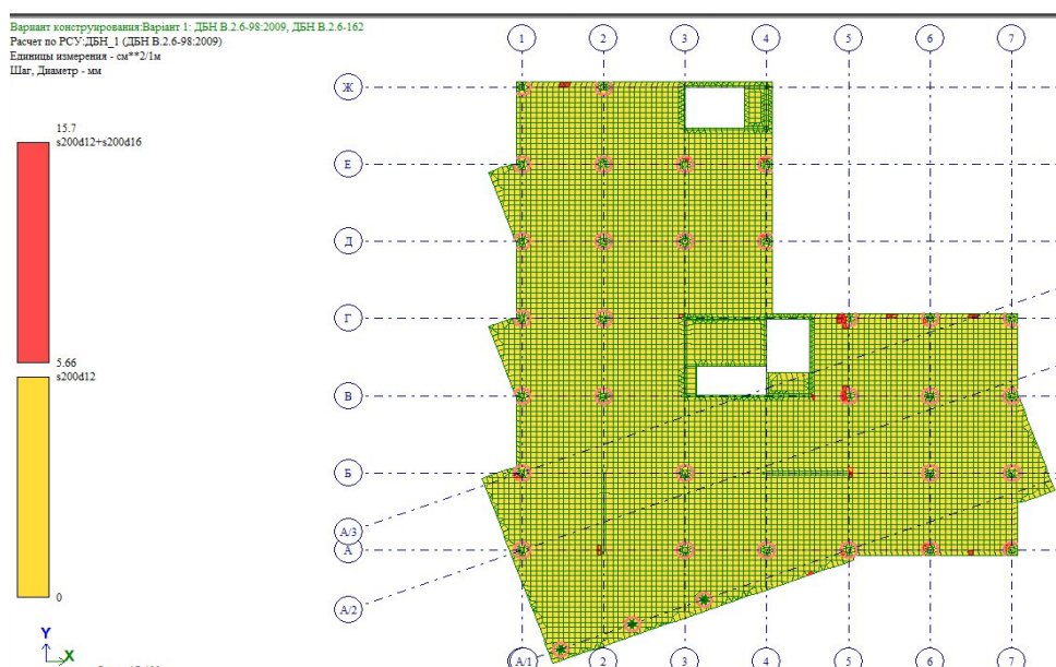
Рисунок 2.45 – Схема нижнього армування монолітної плити перекриття
