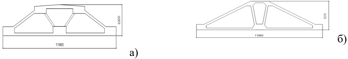
Рисунок 3.24 – Підкрівляні ферми: а – за серією ПК-01-110/68; б – за серією ПП-01-04/68 (вип. I)
