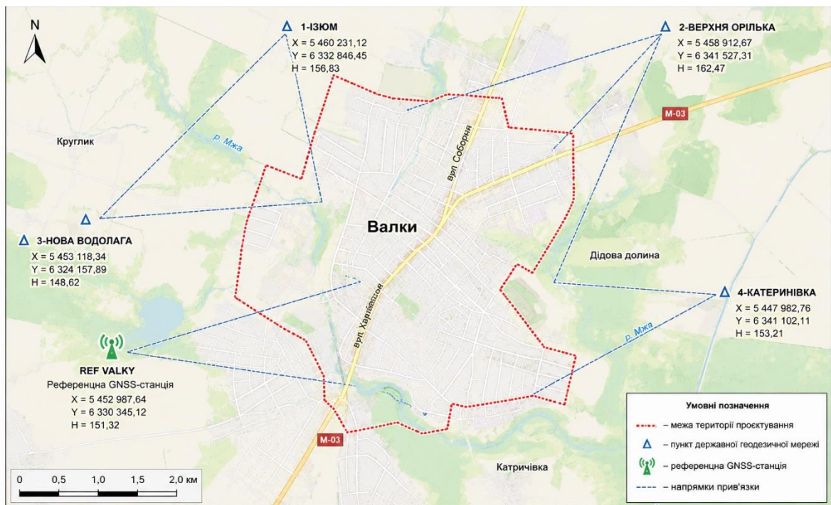
Рисунок 3.3 – Схема прив'язки проєктованої планово-висотної основи до пунктів державної геодезичної мережі та референцних GNSS-станцій
