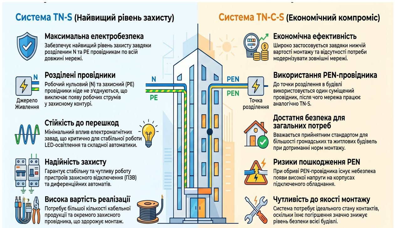
Рисунок 3.2 – Порівняльна характеристика систем заземлення
