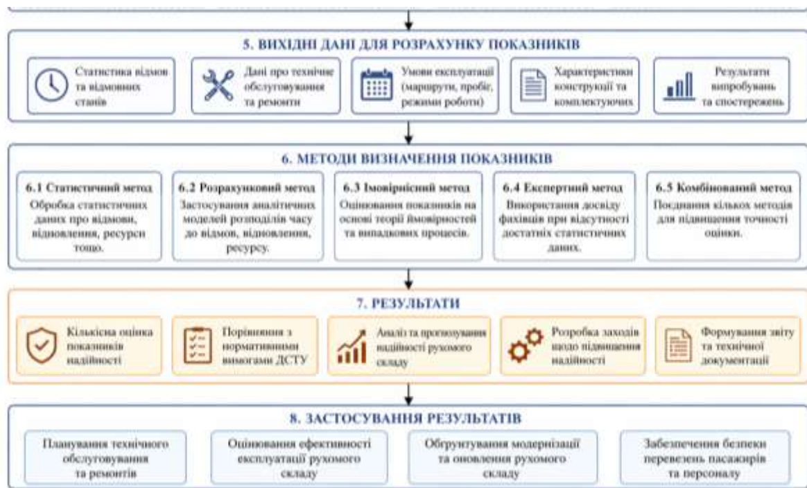
Рисунок 1.1 – Алгоритм визначення головних показників надійності рухомого складу міського електричного транспорту (трамвая, тролейбуса) відповідно ДСТУ [1]
