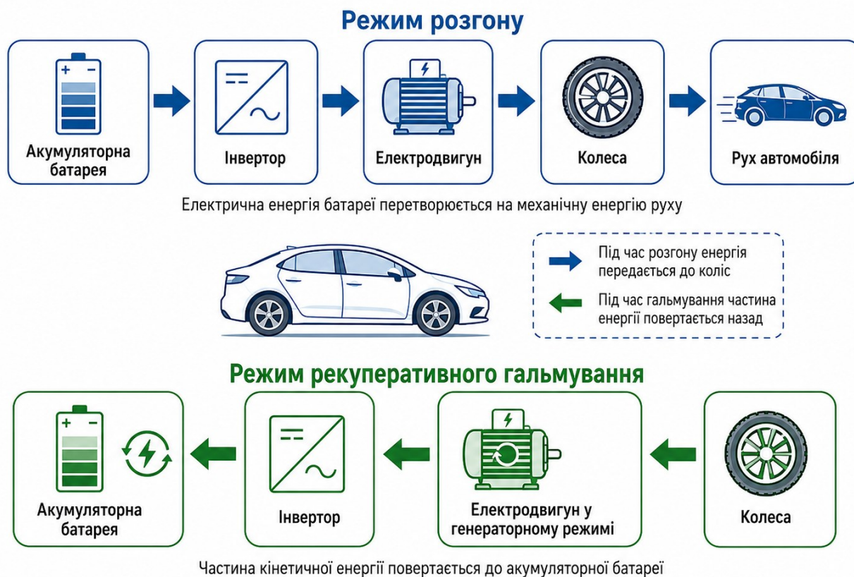
Рисунок 1.2 – Енергетичні потоки електромобіля під час тяги та рекуперативного гальмування
