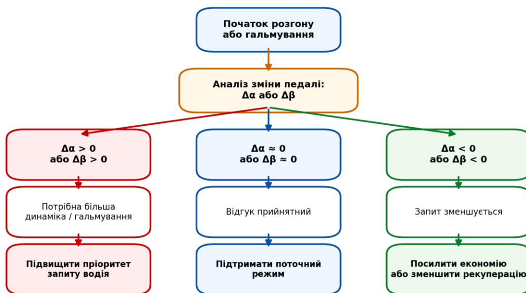
Рисунок 2.5 – Логіка адаптації алгоритму до дій водія
