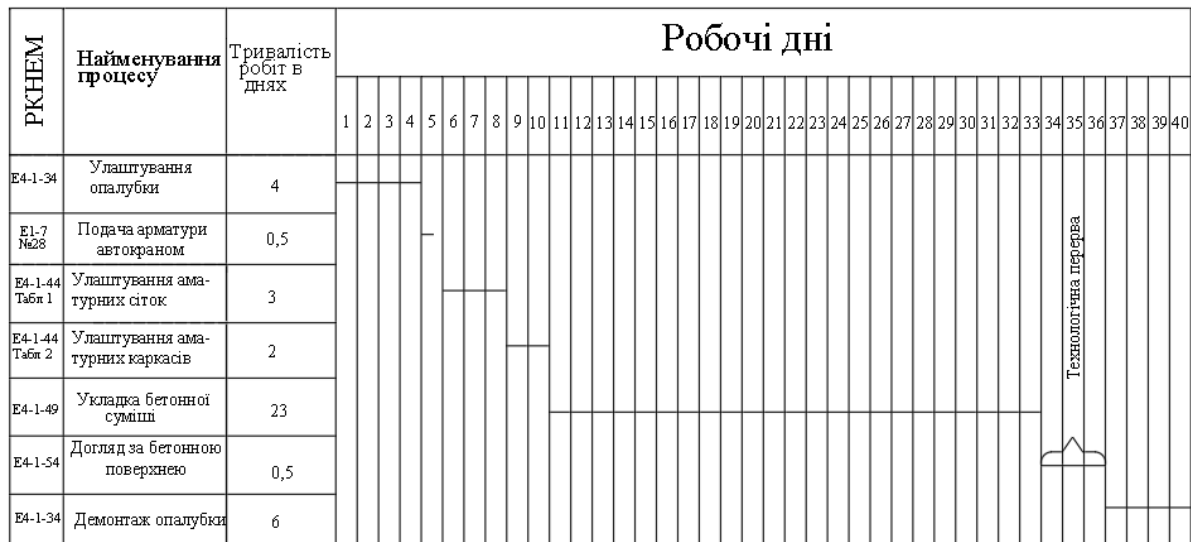
Рисунок 3.1 – Графік робіт з улаштування монолітного ростверку
