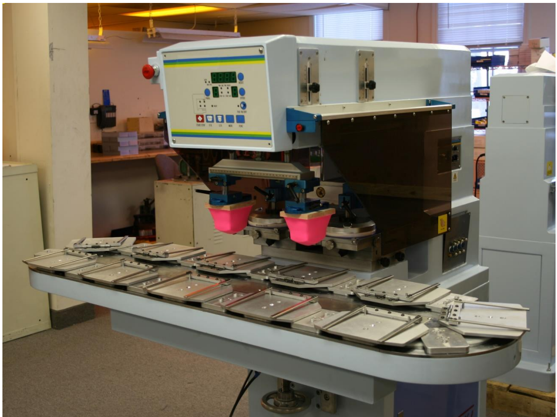
Рисунок 2.2. Тамподрук: нанесення графіки на криволінійні та складні поверхні сувенірів
