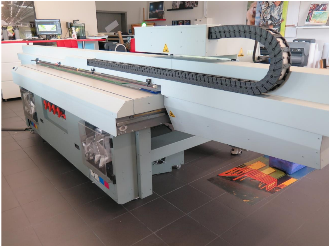
Рисунок 2.3. УФ-плоскодрук: прямий друк на твердих матеріалах (пластик, дерево, акрил)
