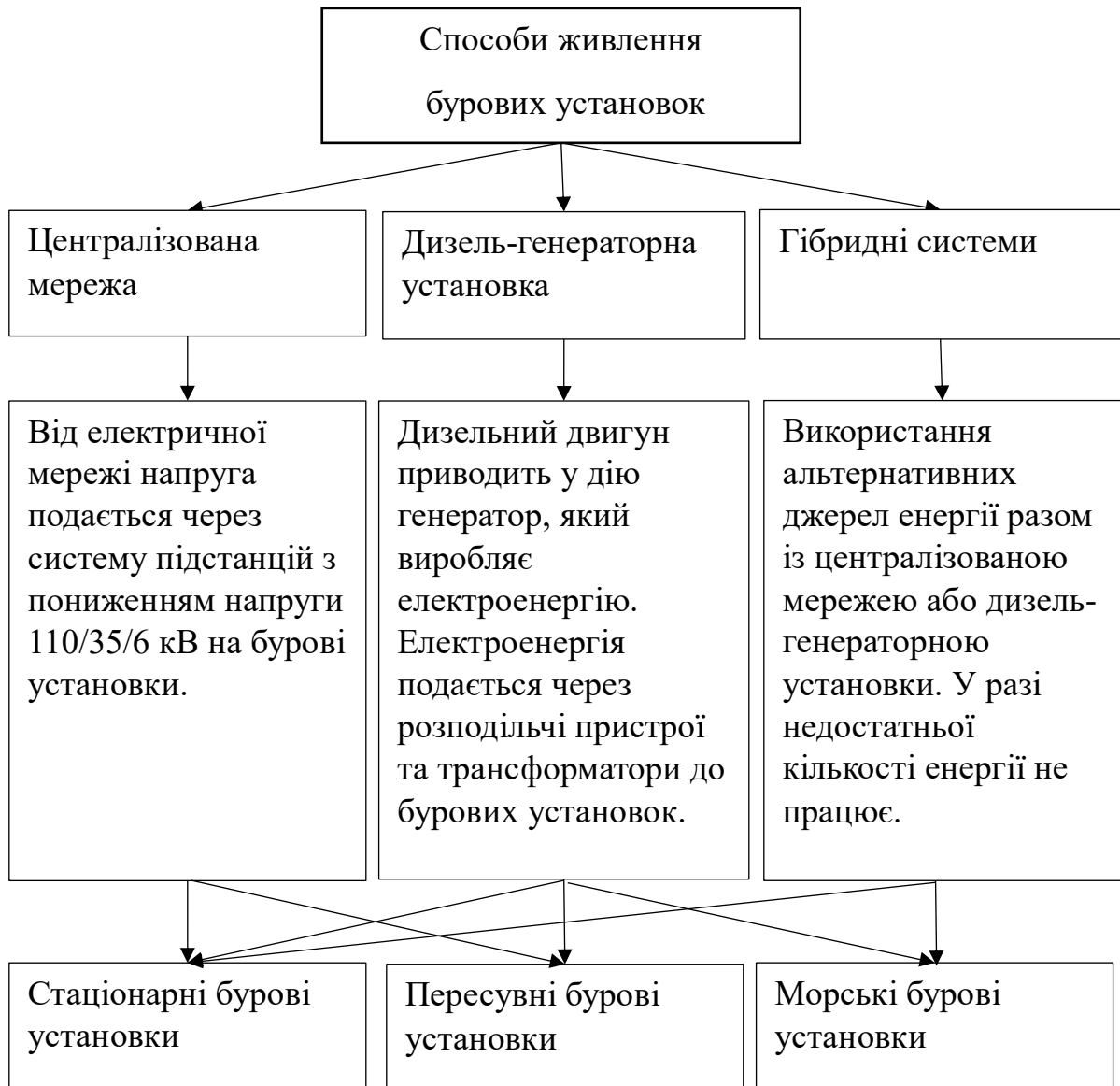
Рисунок 1.2 – Класифікація систем живлення бурових установок
