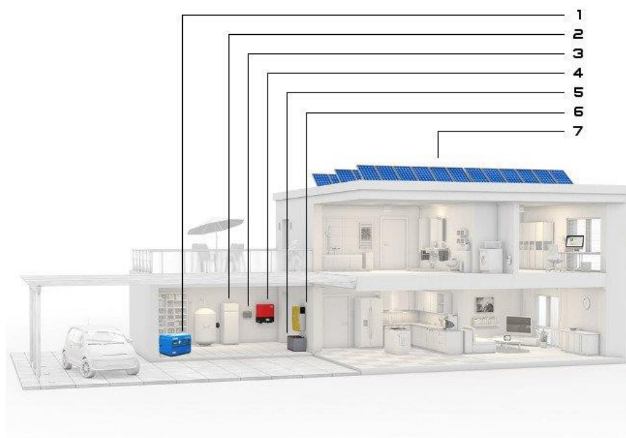
Рисунок 1.1 – Система автономного електропостачання на основі перетворення сонячної енергії та генерації електрики за допомогою паливного генератора:
