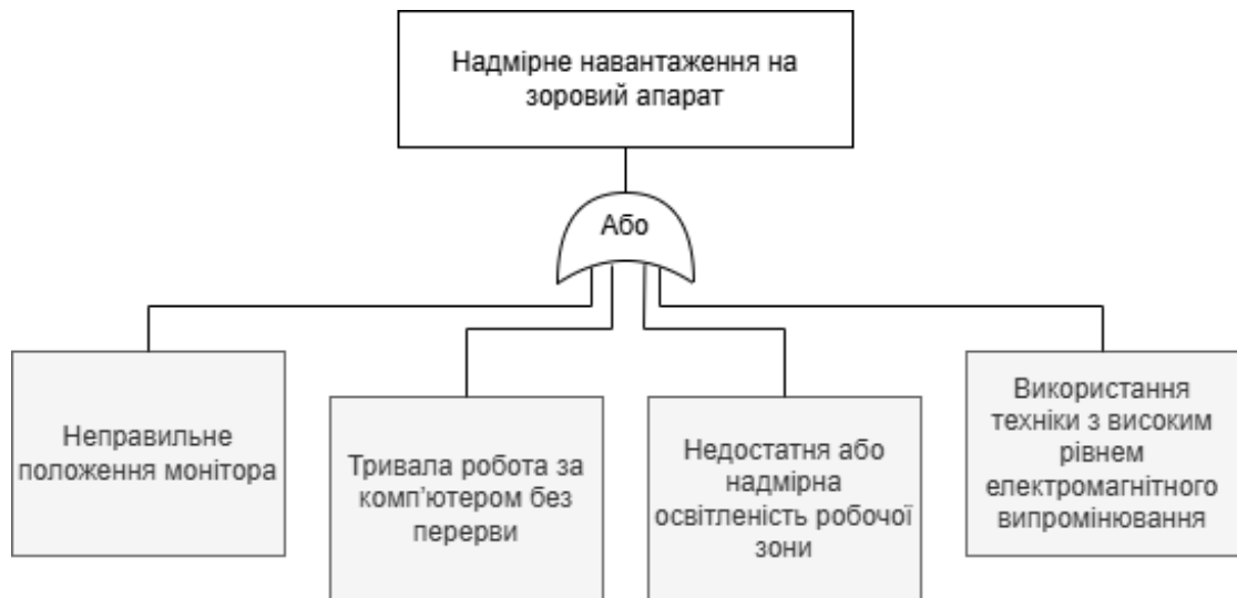
Рисунок 4.1 – Дерево відмов небезпеки надмірного навантаження на зоровий апарат
