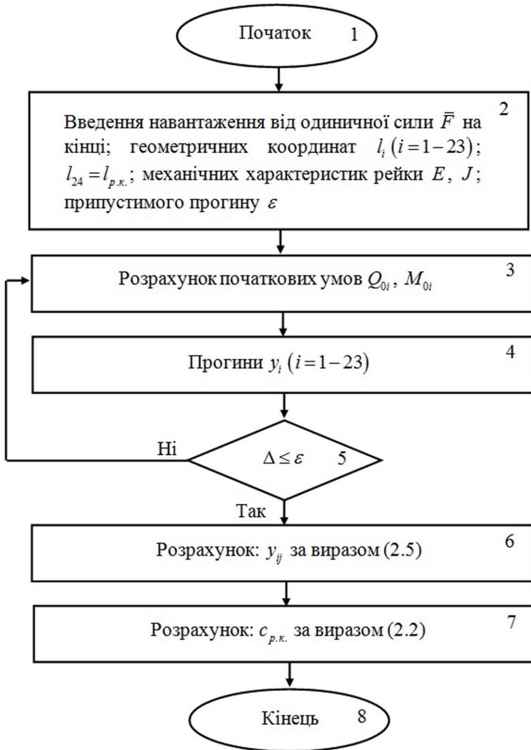
Рисунок 2.4 – Блок-схема розрахунку прогину рейки
