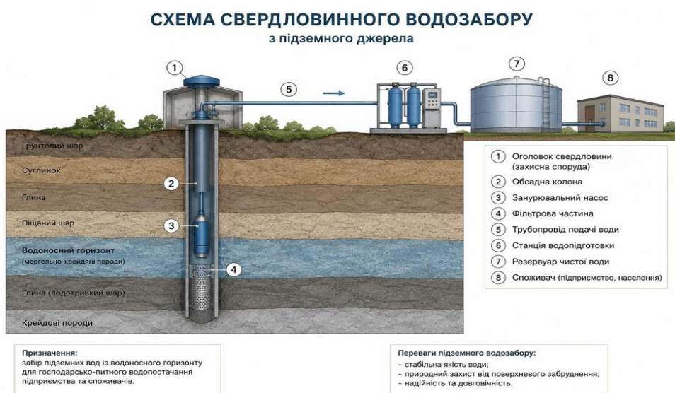
Рисунок 2.2 – Схема свердловинного водозабору [25]
