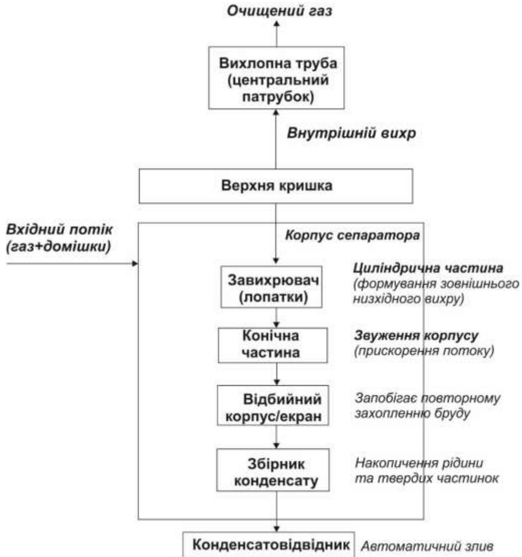
Рисунок 2.6 - Структурна схема циклонного пиловловлювача
