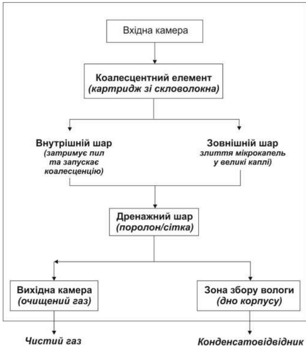
Рисунок 2.7 - Структурна схема коалесцентного фільтр-сепаратора
