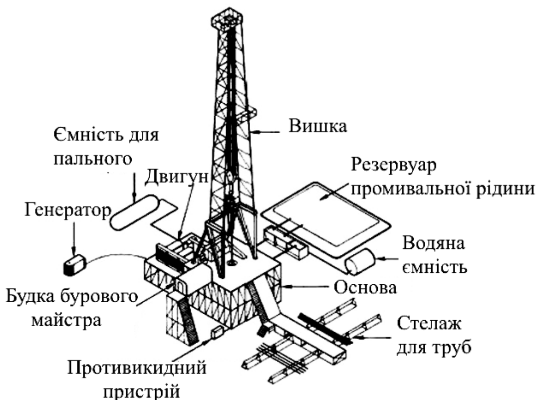
Рисунок 2.5 – Схема бурової установки для буріння на нафту і природний газ
