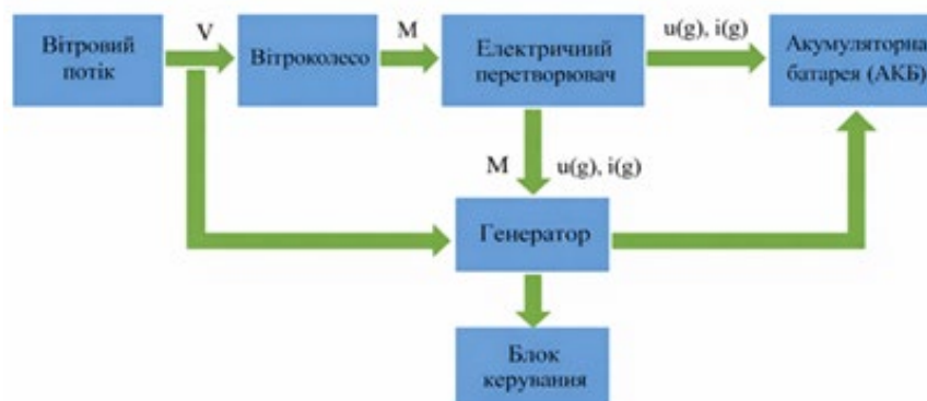
Рисунок 2.1 – Загальна функціональна схема вітрогенератора з використанням блоку управління
