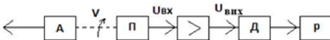
Рисунок 2.11 - Схема керування лопатями вітрогенератора
