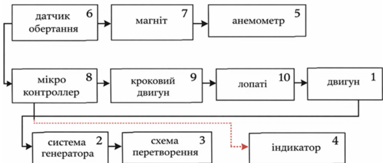
Рисунок 2.10 – Загальна схема системи управління ротором:
