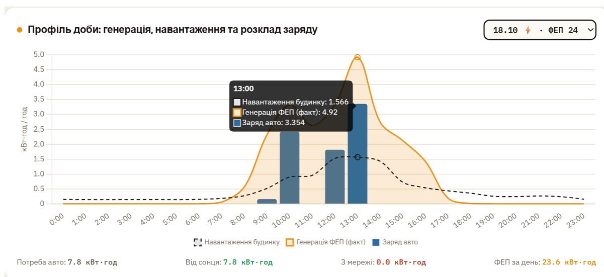
Рисунок 3.12 – Добовий графік генерації, навантаження та заряджання електромобіля
