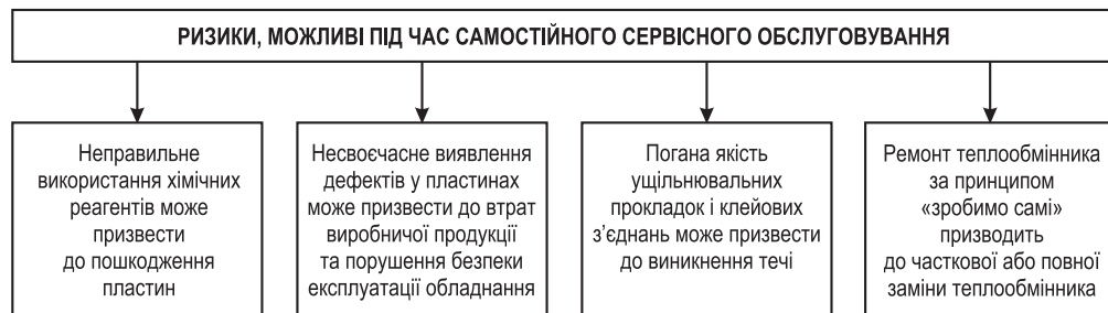
Рисунок 13.8 – Ризики, можливі при самостійному сервісному обслуговуванні
