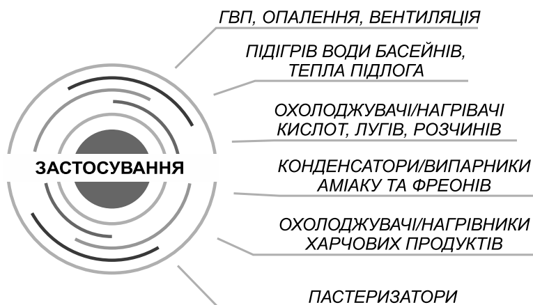
Рисунок 9.6 – Сфера застосування пластинчастих теплообмінників
