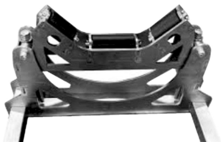
Рисунок 7.23 – Роликова рухома опора
