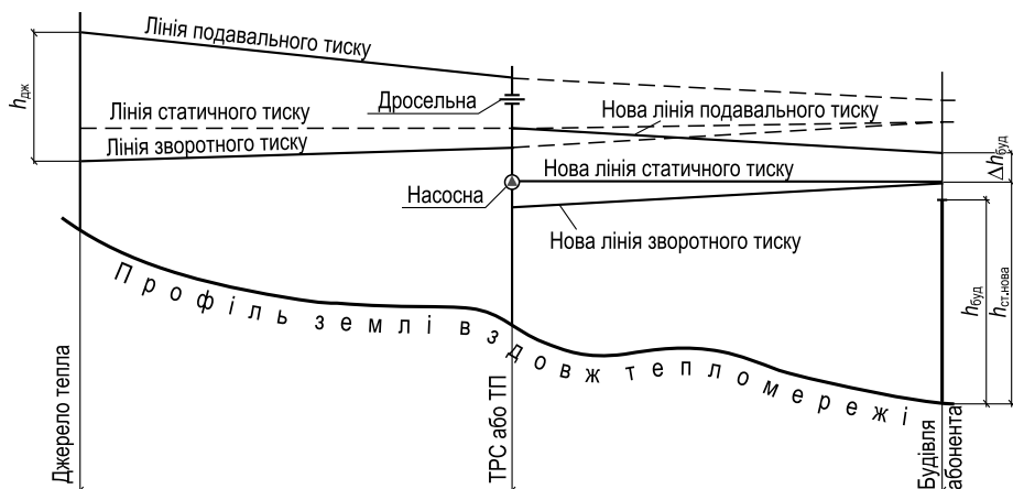
Рисунок 8.2 – П'єзометричний графік при влаштуванні насосної на зворотній магістралі та дросельної на подавальній
