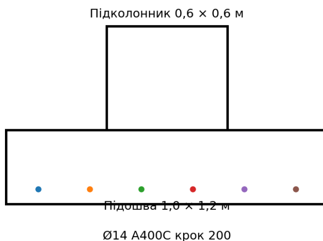
Рисунок 2.2.2.2 - Конструктивна схема стовпчастого фундаменту ФМ-2
